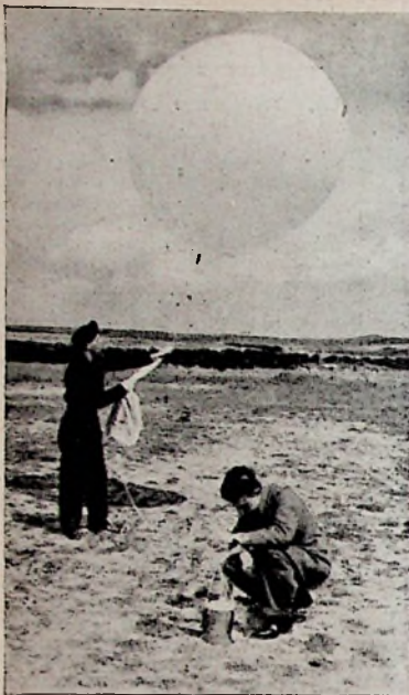
Het oplaten van een ballon met radio-sonde.
